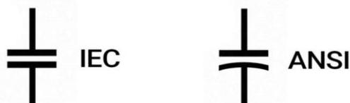
Рисунок 4.11 – Обозначение конденсатора
